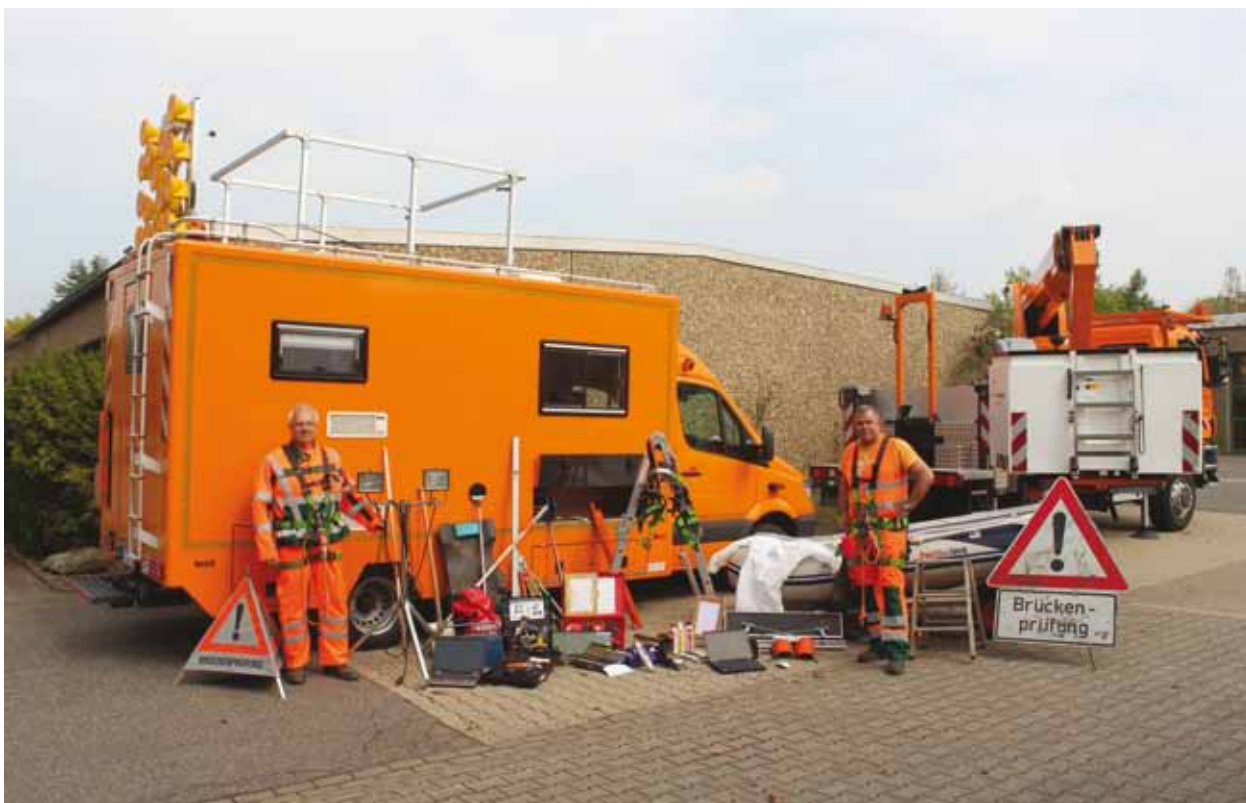
Bild 38: Prüfwagen mit Teilen der Ausrüstung für die Brückenprüfung
