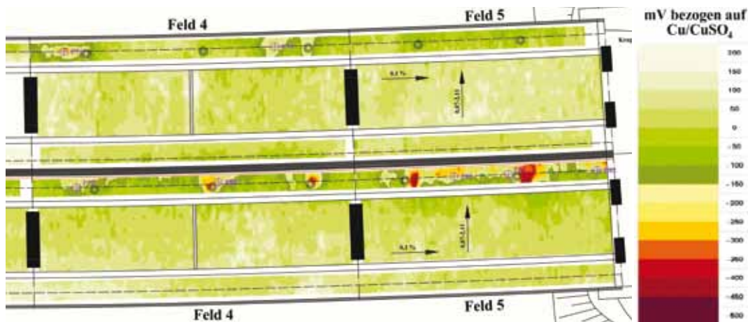
Bild 13: Potentialfeldmessung am Überbau der Heubachtalbrücke
