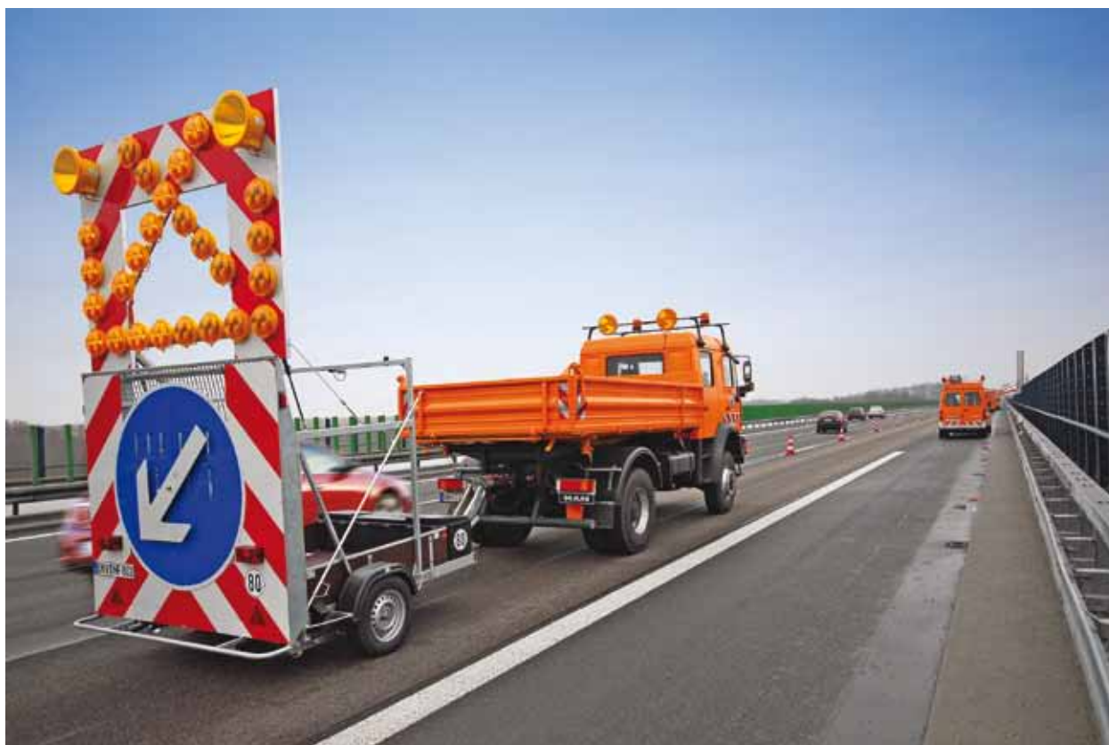
Bild 42: Sicherungsfahrzeug zur Verhinderung des Anpralls an ein Brückenuntersichtgerät
